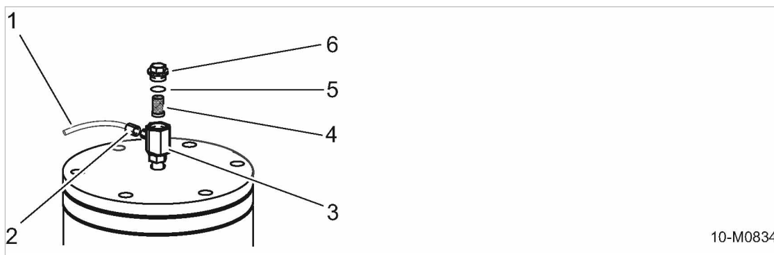
Fig. 32 Réaliser l'entretien du collecteur de poussière du réservoir séparateur d'huile
