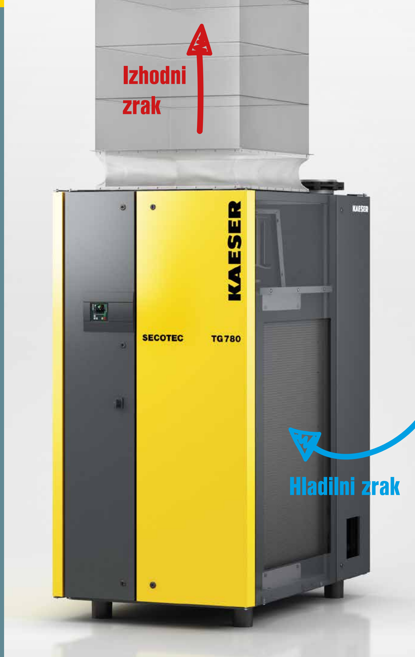
Slika: usmerjanje hladilnega zraka (rdeče) pri hladilnem sušilniku SECOTEC serije TG
