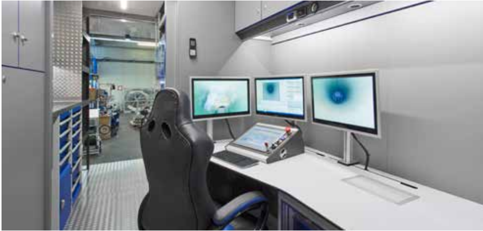
Billedet øverst viser de avancerede saneringskøretøjer, som har alt det udstyr om bord, der er nødvendigt for at anvende den innovative UV-liner-metode. Billedet herunder viser et kig ind i saneringskøretøjet.
