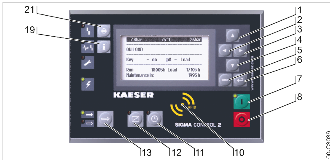
Fig. 5 Elementos de controle
