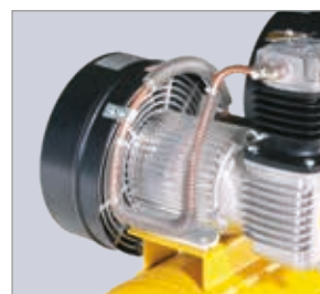
Moto-compresseur à entraînement direct sur le bloc compresseur, robuste et de grande longévité grâce à la petite vitesse de rotation de seulement 1500 tr/min
