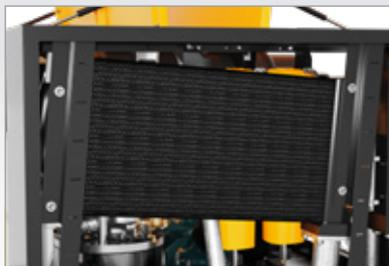
**Refroidisseur final d'air comprimé
