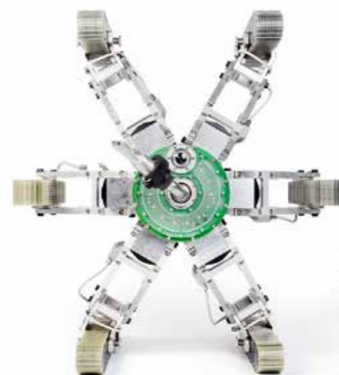
Robot JETTY vyvinula firma Eisschmitt ve spolupráci s ČVUT v Praze. Využívá se u velkých zařízení a v případech mimořádně silného znečištění.
