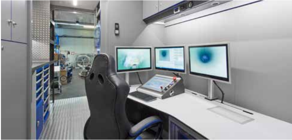
Foto nahoře: Hightech sanační vozidla mají na palubě vše, co je potřeba pro použití inovativní technologie UV liner. Foto dole: Pohled do vnitřku sanačního vozidla.
