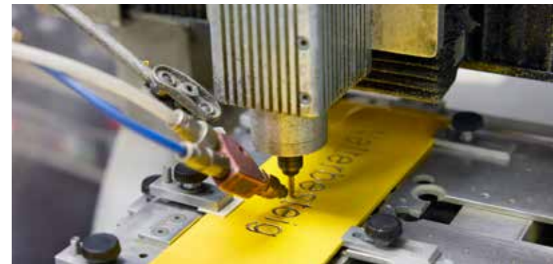
El aire comprimido se utiliza en casi todos los puestos de trabajo de producción: grabado láser de cuchillos de mesa, fabricación de cables, corte de mangueras, grabado (técnica publicitaria).
