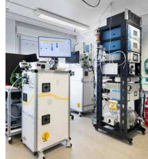
Os altamente sensíveis aparelhos de medição precisam de ar comprimido de elevada pureza.
