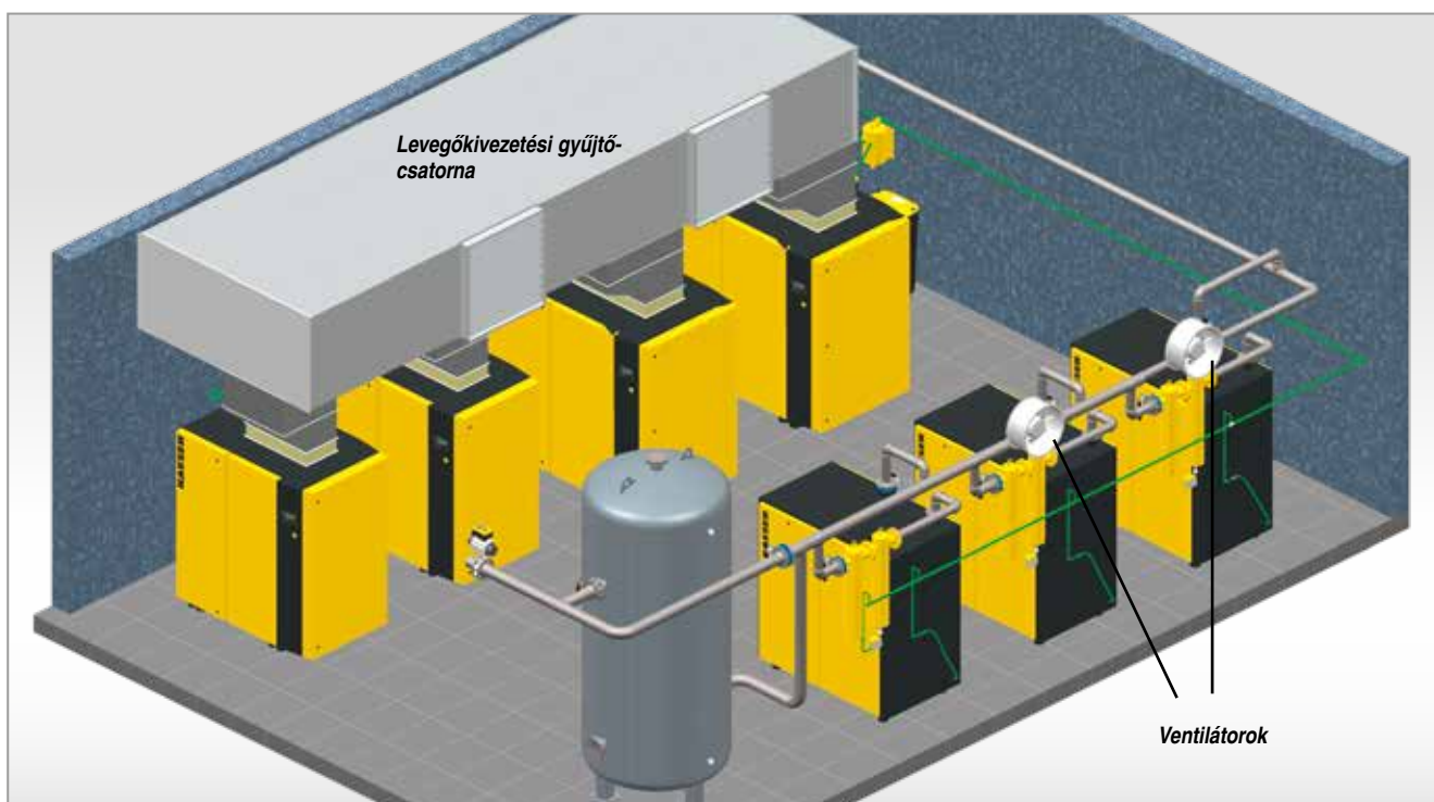
3. ábra: Légtechnikai rendszer gyűjtőcsatornával az összes kompresszorhoz
