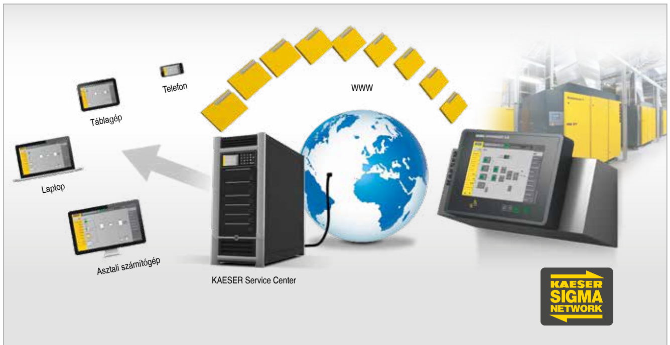
7. ábra: Egy felülrendelt vezérlés teljes körű csatlakozási lehetőségei hozzájárulnak a kompresszorállomás hatékony üzemeltetéséhez
