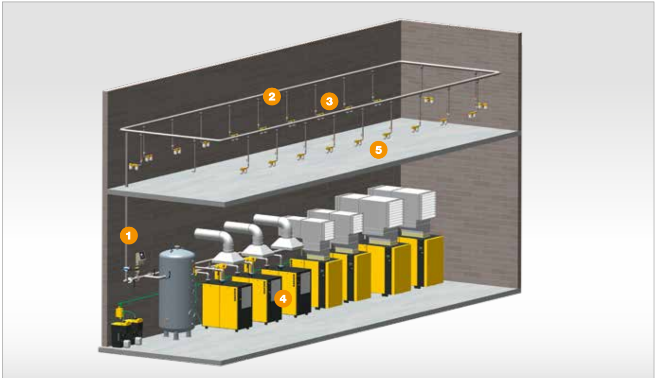
1. ábra: Egy sűrítettlevegő-elosztó rendszer főbb alkotóelemei: Fővezeték (1), elosztóvezeték (2), csatlakozóvezeték (3), szárító (4), karbantartási egység/tömlő (5)
