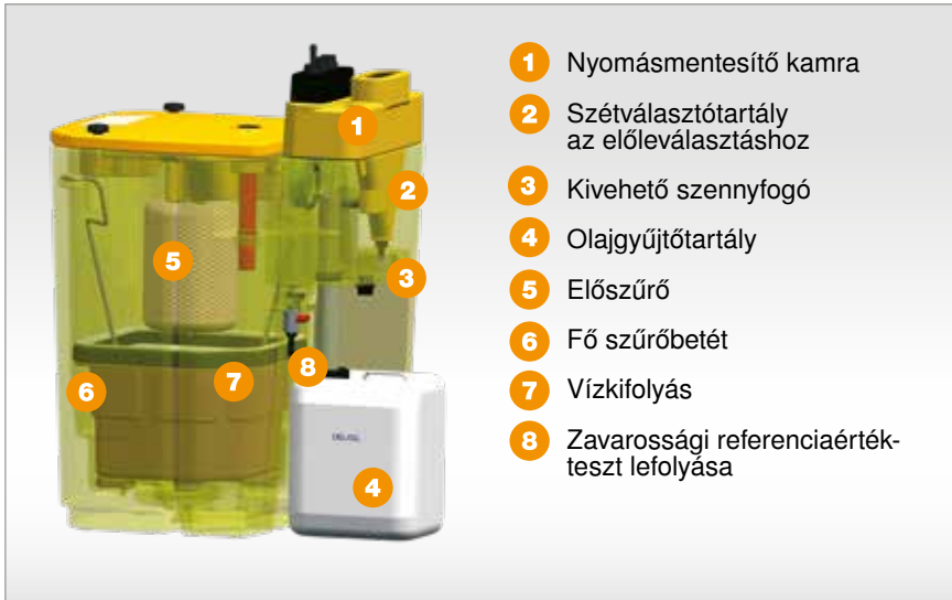
2. ábra: A sűrített levegő-technológiában használt, a nehézségi erő elvén működő kondenzátumszétválasztó rendszer (funkcióábra)
