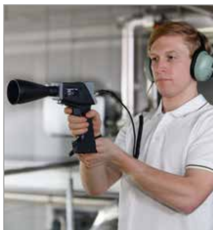
4. ábra: A szivárgások helyének meghatározása ultrahangos módszerrel
