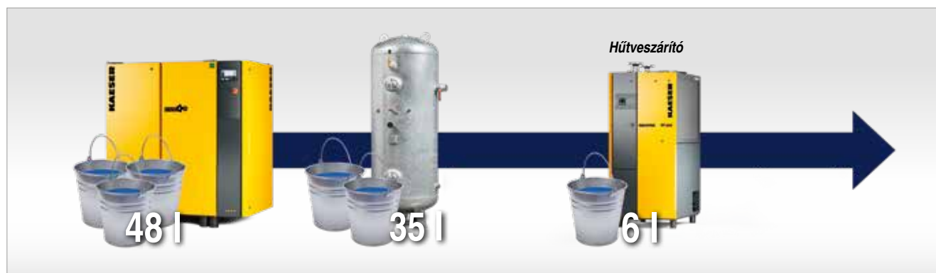
1. ábra: A sűrített levegő előállítás, tárolása és előkészítése során kondenzátum jön létre (az adatok a következők: 10 m 3 /min, 10 bar absz. , 8 óra, 60% F rel és 20 °C)
