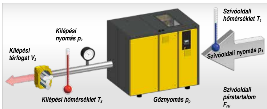
1. ábra: Szállítási teljesítmény mérése az ISO 1217, C függelék (DIN 1945, F függelék) szerint
