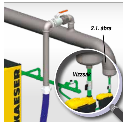
2. ábra: Csővezeték vízcsapdával és kondenzátumleeresztővel
