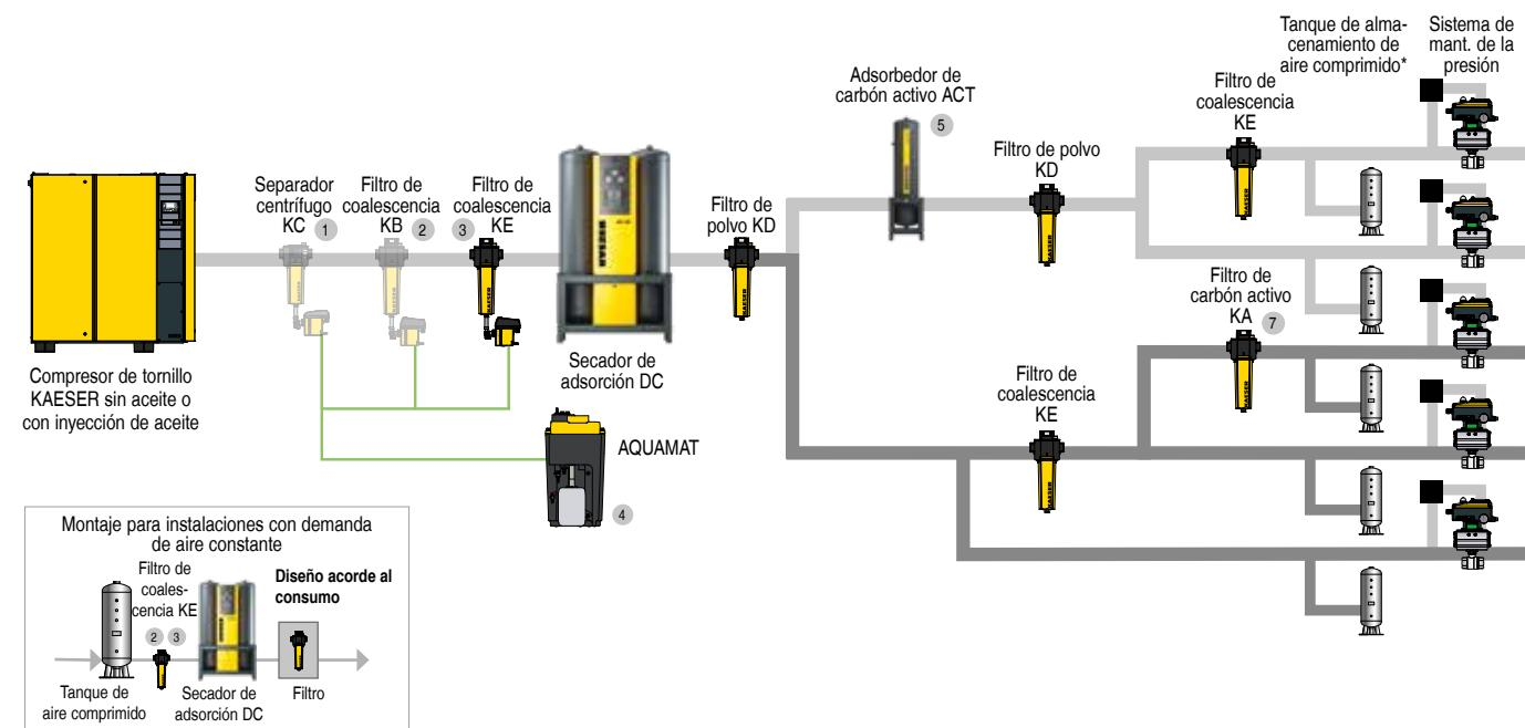
1 Si el compresor lleva un separador centrífugo integrado, no será necesario el KC.
