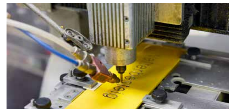
La plupart des postes de production utilisent de l'air comprimé : gravure laser de couteaux de table, fabrication de câbles, découpe de tuyaux, gravure (publicité).
