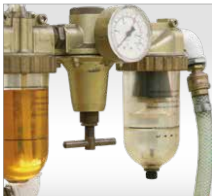
Afb. 6: Onderhoudseenheid met drukregelaar
