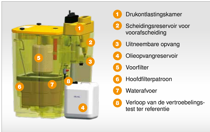
Afb. 2: Condensaatafscheidingssysteem voor persluchttechniek volgens het zwaartekrachtprincipe (afbeelding)
