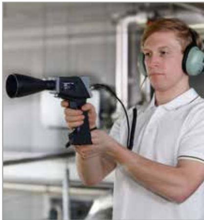
Afb. 4: Ultrasoon lokaliseren van lekken
