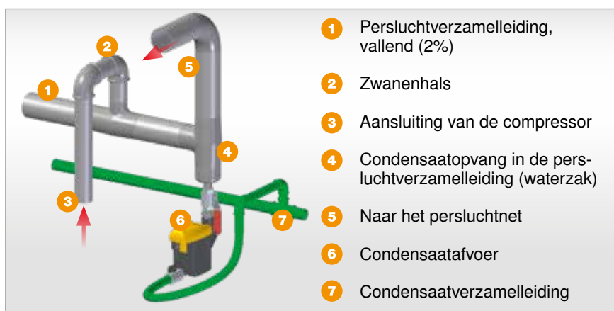
Afb. 3: Waterzak met condensaataftappunt in de vochtige zone van een persluchtsysteem
