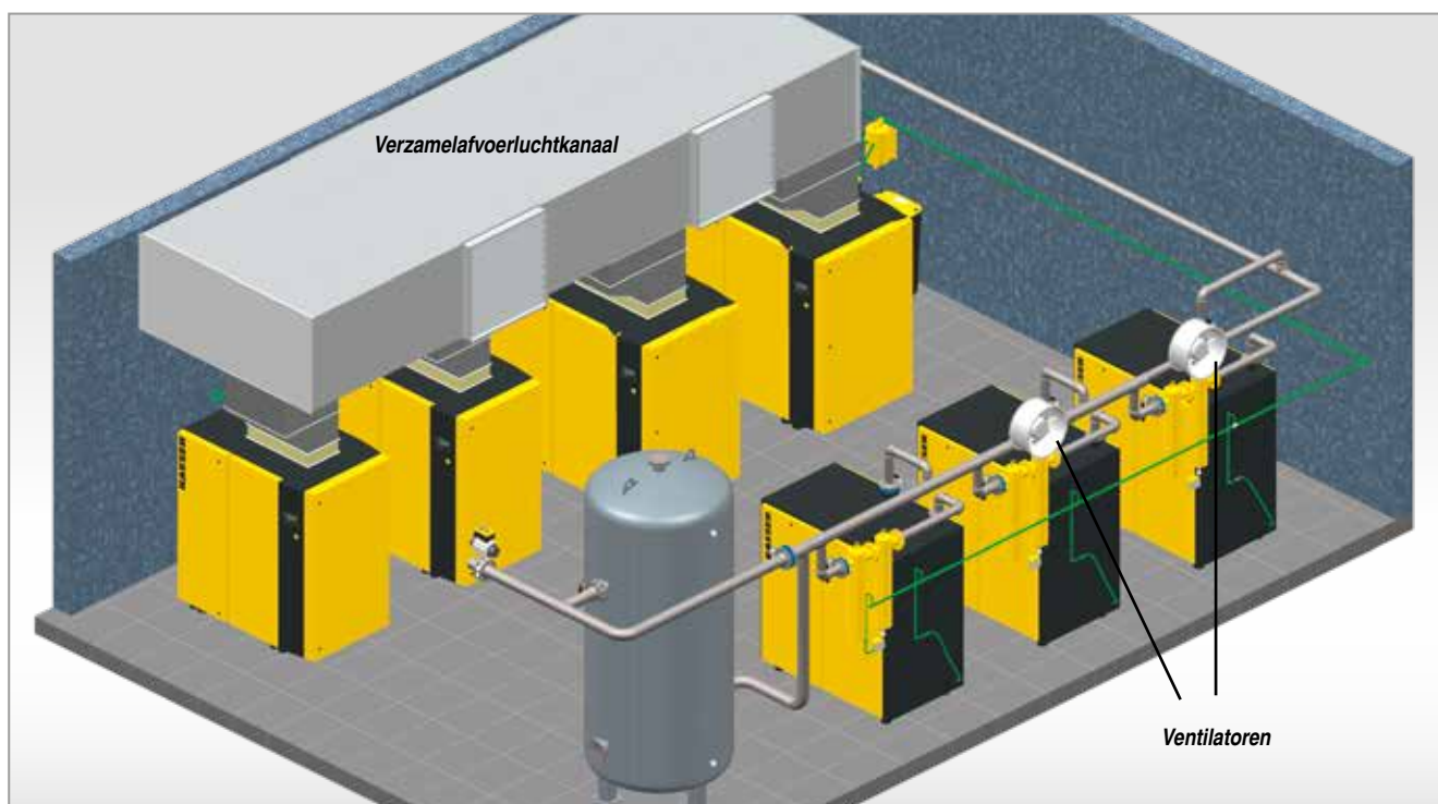
Afb. 3: Afvoerluchtsysteem met verzamelluchtkanaal voor alle compressoren
