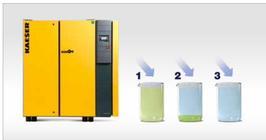
Afb. 1: Elke compressor zuigt met de atmosferische lucht ook waterdamp en verontreinigingen aan. Uit het persluchtcondensaat (afb. 1, 1) dat wordt gevormd, moeten derhalve olie en andere schadelijke stoffen worden verwijderd (afb. 1, 2), voordat het als zuiver water (afb. 1, 3) kan worden afgevoerd
