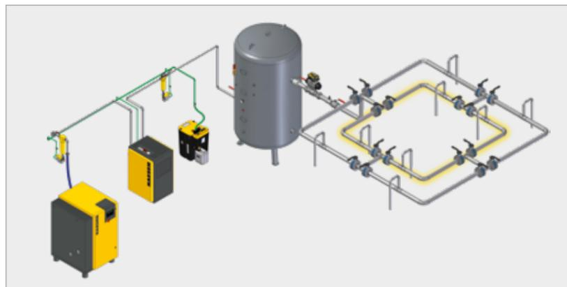
Fig. 1 : Modernisation de la tuyauterie par la pose d'une seconde boucle
