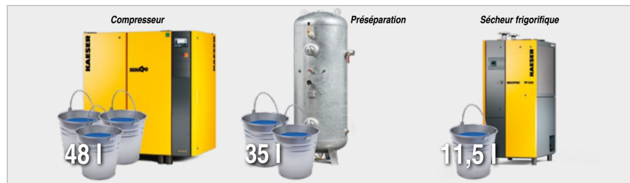
Fig. 1 : La production, le stockage et le traitement de l'air comprimé génèrent des condensats (quantités indiquées pour 10 m<sup>3</sup>/min, 10 bar abs, 8 h, 60 % F<sub>rel</sub> et 20 °C)
