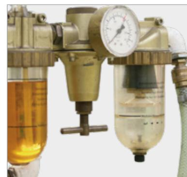
Fig. 6 : Unité d'entretien avec manodétendeur
