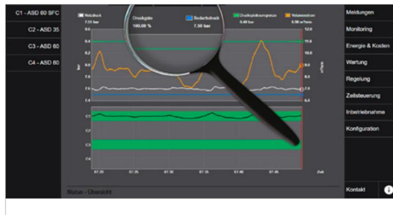
Fig. 5b : Courbes de débit et de pression avec surveillance de la stabilité de la pression
