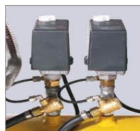
Deux pressostats Démarrage à vide des compresseurs sans contre-pression, pressions d'enclenchement et d'arrêt réglables individuellement.
