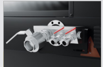
Conexión de aire comprimido
