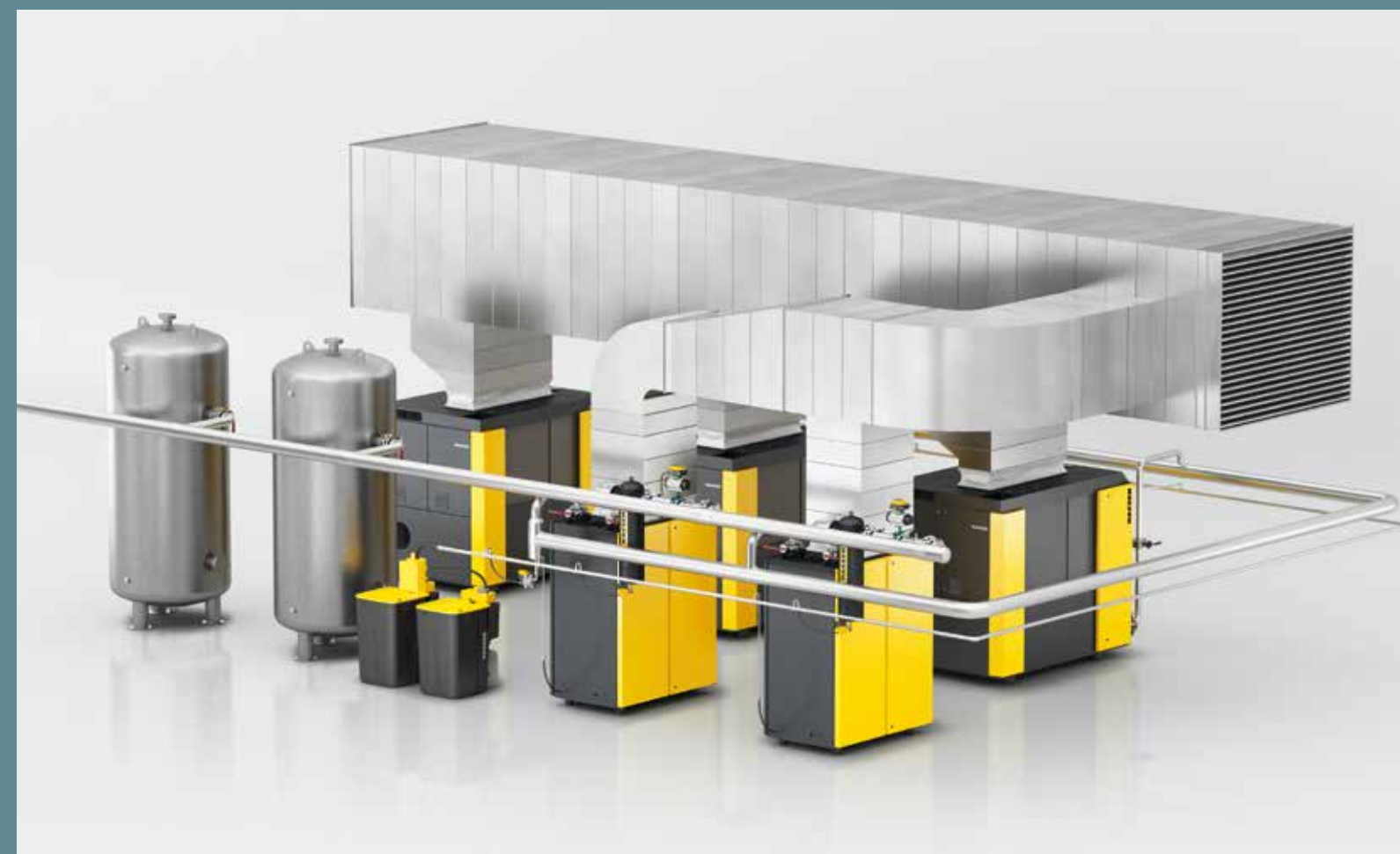
Rys.: Przykładowa stacja z kanałem zbiorczym do sprężarek i osuszaczy chłodniczych
