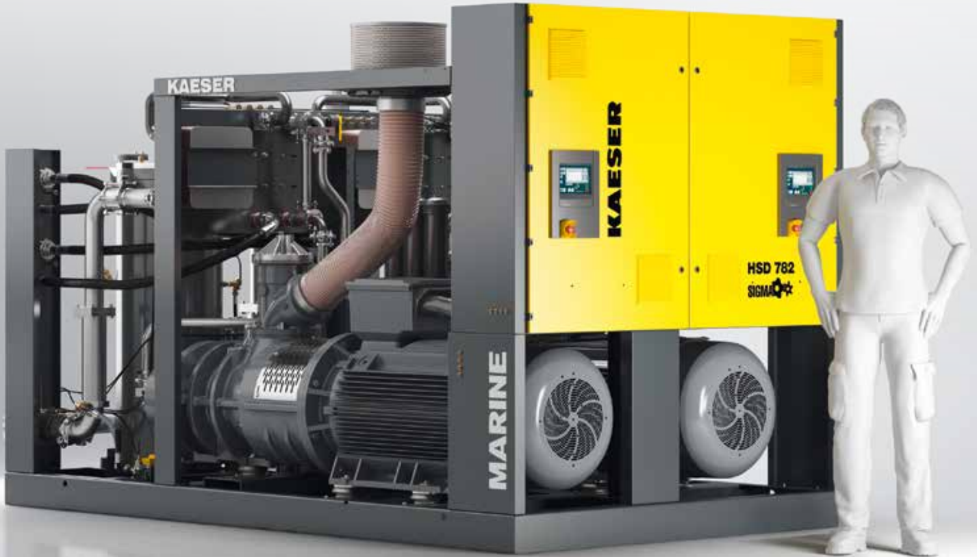
이미지: HSD 782 모터 출력: 360~630kW FAD: 2.590~5.110m³/h 기준 압력: 8~14 bar(g)
