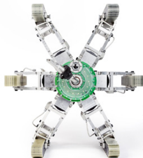
Der JETTY-Roboter ist eine Entwicklung von Eisschmitt in Zusammenarbeit mit der TU Prag. Er kommt bei Großanlagen und besonders starker Verschmutzung zum Einsatz.
