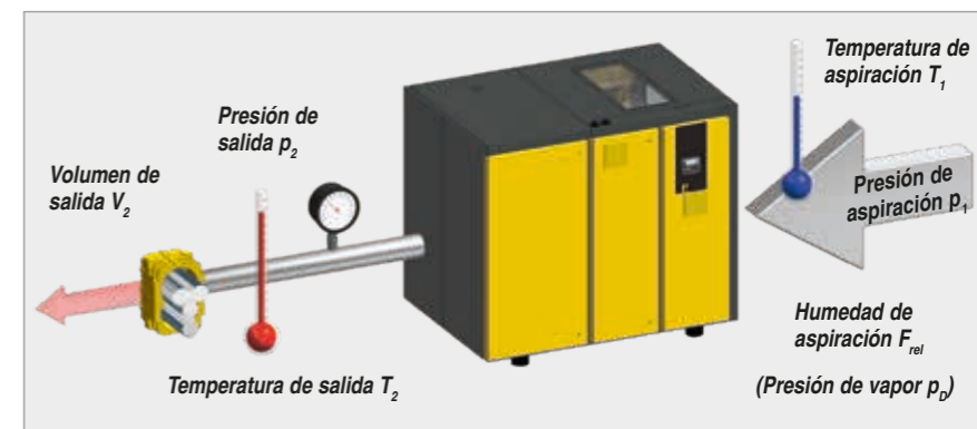
Imagen 1: Medición del caudal según ISO 1217, anexo C.
