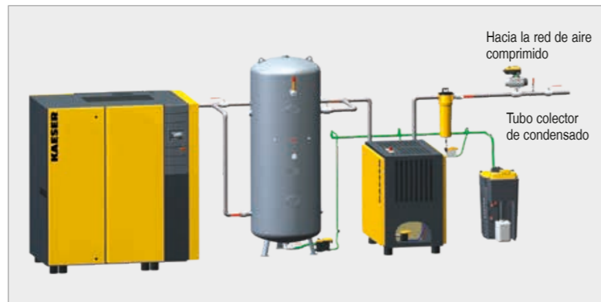
Imagen 1: En todos los sistemas de aire comprimido se forma condensado en puntos concretos.
