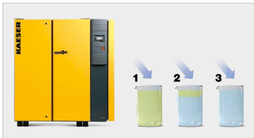
Imagen 2: Todos los compresores aspiran vapor de agua e partículas junto con el aire atmosférico. Por eso, antes de verter el condensado (imagen 2 [1]) a la canalización (imagen 2 [3]), es necesario eliminar el aceite y las demás sustancias contaminantes que contiene (imagen 2 [2]).
