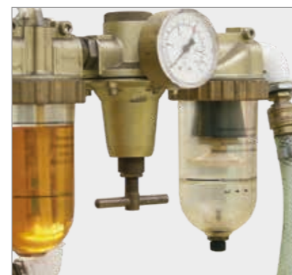
Imagen 6: Unidad de mantenimiento con reductor de presión.
