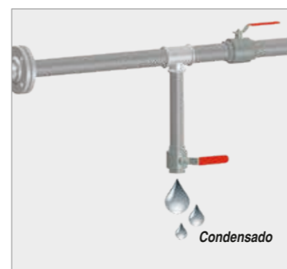
Imagen 7: Control de humedad en la tubería de salida de aire comprimido.
