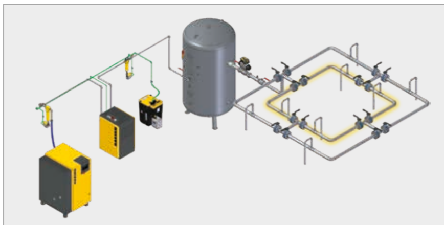
Imagen 1: Saneamiento de una tubería de aire comprimido instalando un segundo anillo de distribución.
