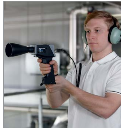
Figura 4: Localización de fugas por ultrasonidos
