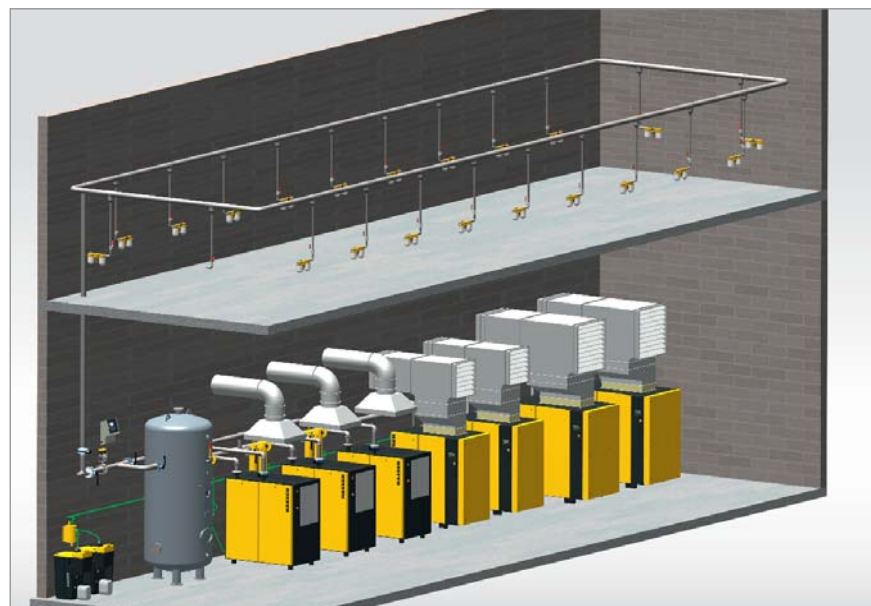
Ejemplo de una estación con sistema de ventilación y ventilación adicional controlada por termostato para los secadores refrigerativos
