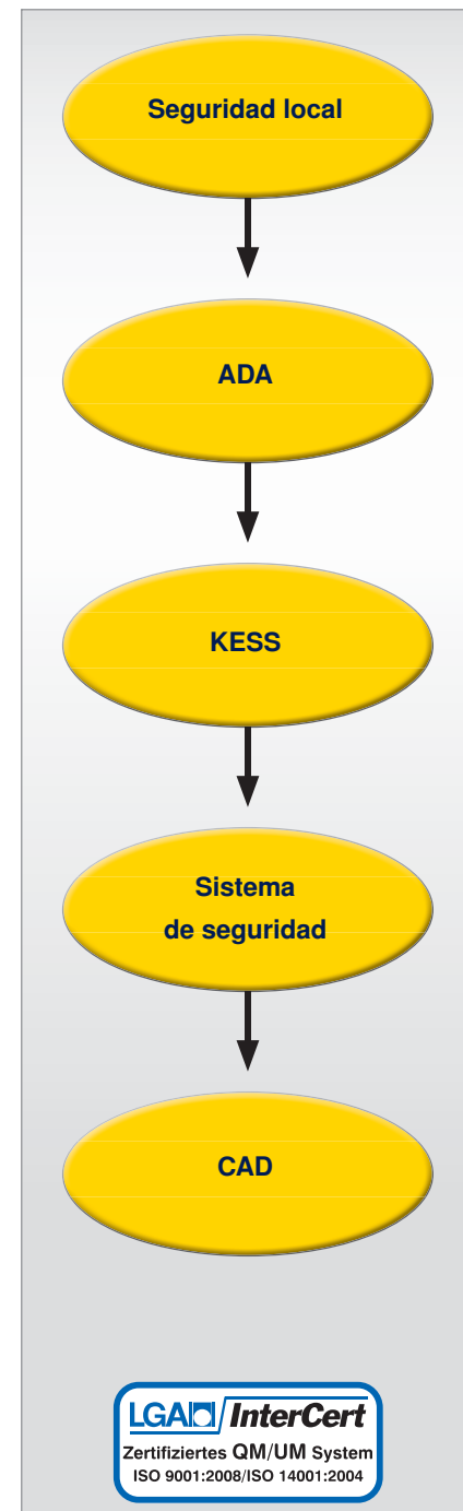
Figura 1: Sistema de análisis de la demanda de aire comprimido de KAESER Kompressoren
