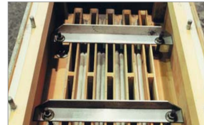
Figura 2b: Esterillas filtrantes (lado del compresor)
