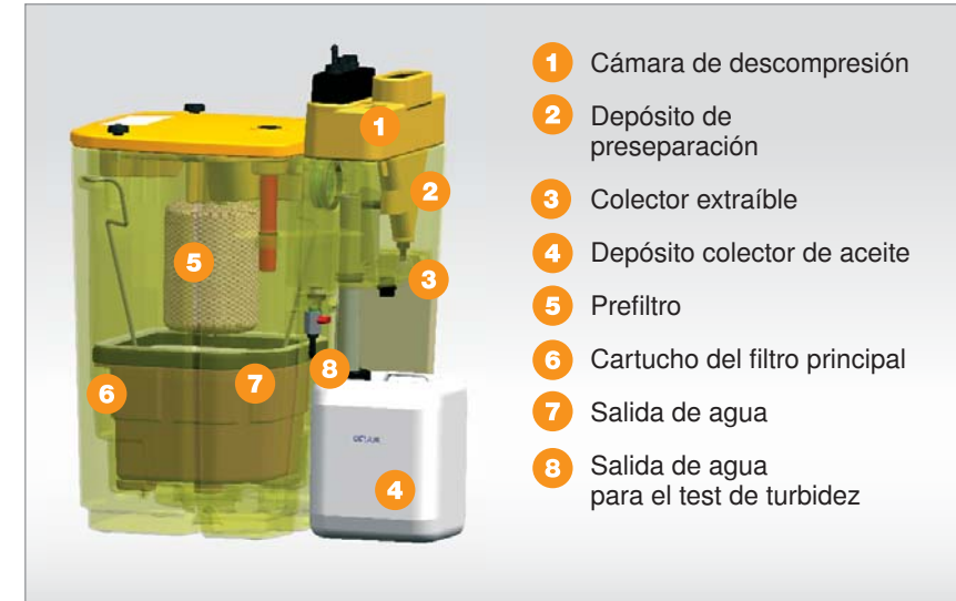
Figura 2: Sistema de separación de condensado de aire comprimido por gravedad (esquema de funcionamiento)
