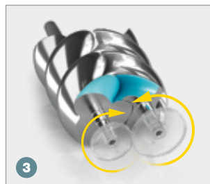
3 przesunięcie na stronę ciśnieniową
